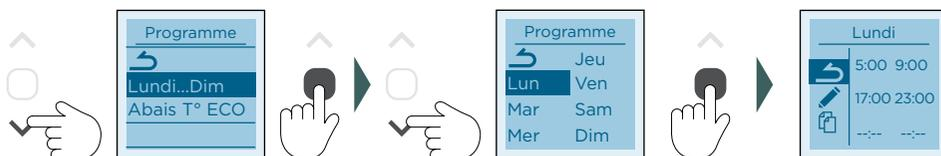
Vous pouvez programmer jusqu'à 3 plages de température « Confort » pour chaque jour de la semaine. En dehors de ces plages, l'appareil effectue un abaissement de température (réglé par défaut à -3,5°C).
