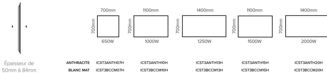
(au mur : épaisseur totale de 88mm pour les horizontaux et 90mm pour les verticaux de 650W à 1250W ; 122mm pour les horizontaux et 124mm pour les verticaux de 1500W à 2000W)
